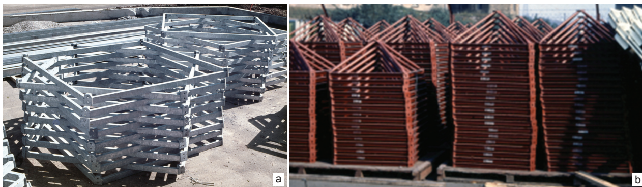
Il. 5. Komponenty przemysłowe: a) elementy warstwy dolnej, b) piramidy tworzące warstwę górną i środkową (fot. R. Motro)
